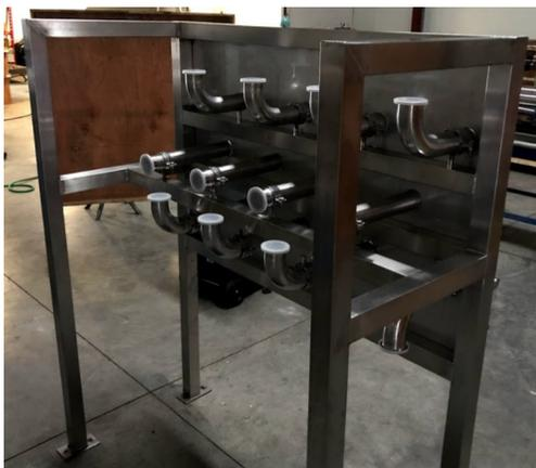
**SOLUCIÓN:** Se diseña un Panel de transferencia con telefonos, esto permite realizar las conexiones de los distintos tanques hacia los puntos de interes, llenadoras, bombas y tanques de reservas usando las combinaciones de los telefonos de transferencia.
