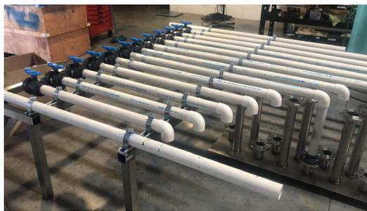
**SOLUCIÓN:** Para este caso se diseñaron líneas de inyección de químicos independientes. Con alimentación por gravedad y un sistema de tolva con válvulas automáticas, a su vez un tanque con celdas de carga permitía operar de forma controlada. Realizar la mezcla por recetas de los productos químicos para la formación del producto final.
