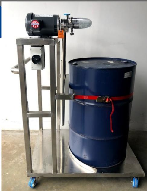
**SOLUCIÓN:** Se diseña un sistema móvil, que incluye una bomba y un sistema de descarga de tambores. para bombear desde la planta baja hasta las marmitas de coccion. La misma incluye un bomba centrifuga sanitaria con conexiones Clamp 1.5" x 1.5". Botoneras montadas en el carro y baston de succion.
